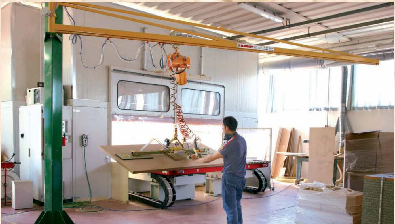
Gru a bandiera a colonna con braccio in profilato a canalina con ventosa tipo PNT2F a due piastre funzionante ad aria compressa, con comandi sul manico.
