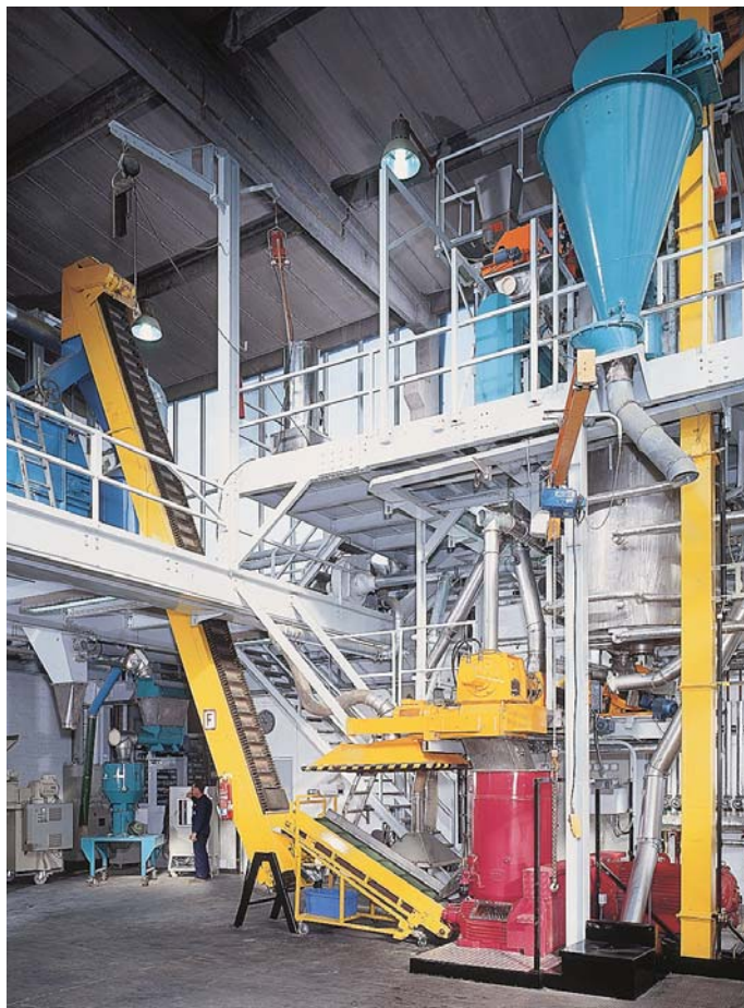
Instalație de testare cu dozator, malaxor continuu, reactor hidrotermic, Expander tubular, Extruder OEE, presă cu matriță plană, uscător/răcitor cu bandă, Rotospray, Brizurator.
