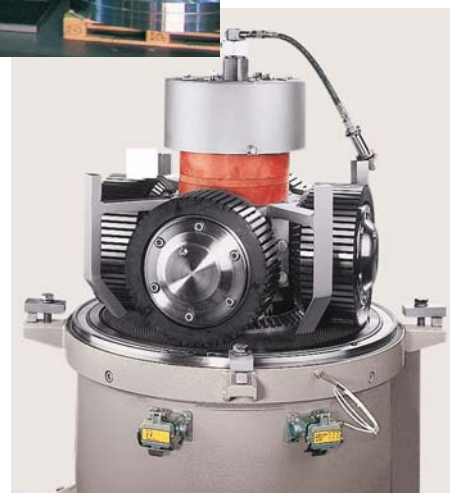
Transmisie de role pentru produse cu calități de patinare extreme.
