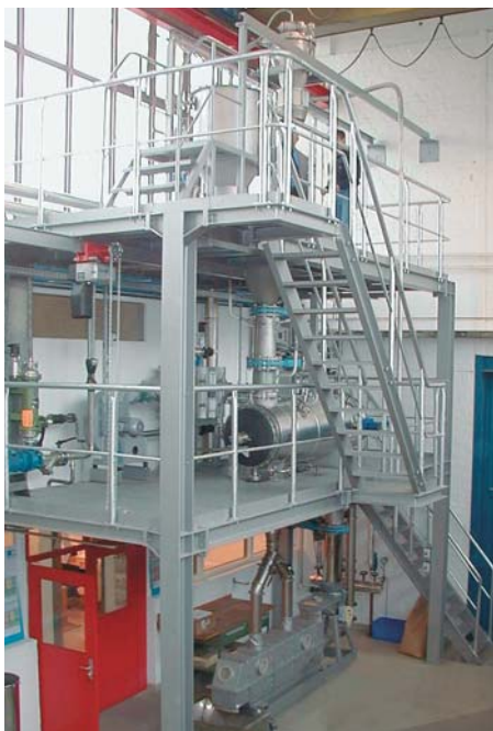
Instalația de testare SCHULE cu sistem pentru fierberea cerealelor, parboiling, alimente, Bulgur și multe altele.
