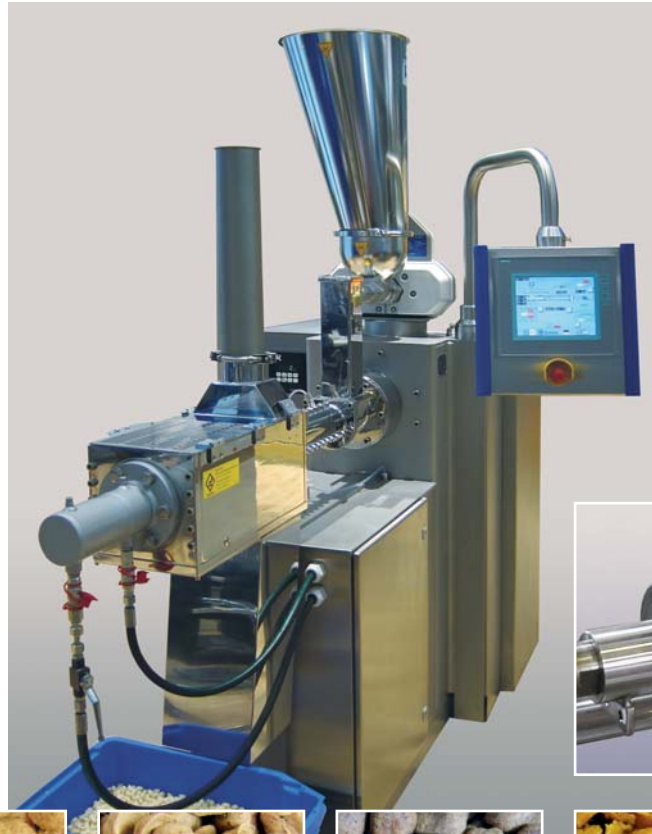
Extruder OEE 8 cu matriță reglabilă hidraulică pentru utilizarea în laborator sau producții mici
