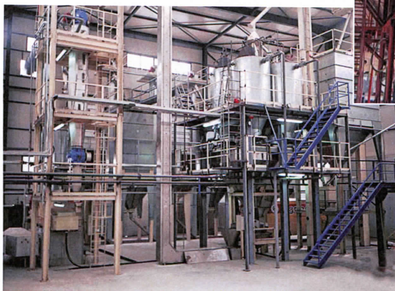
Instalații Parboiling în flux continuu in Grecia (pentru productivitate mare și mică)
