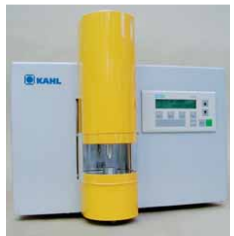
Verificatorul de duritate al granulelor, evaluare individuală manuală.
